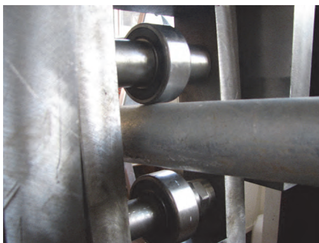
Figura 3-3 Accessorio per il trasferimento dello spostamento della traversa della macchina di prova al traverso del dispositivo di collegamento sottoposto a prova
